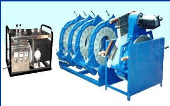
■ 1、焊接之前首先检查热熔焊机动态，检查各部位是否正常移动，加热板是否加热，铣削装置能否正常转动，液压系统是否正常供油，机架是否正常移动。
